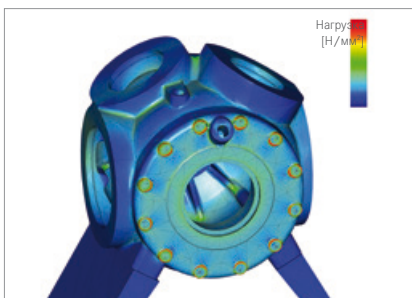
Слева вверху: поршень Слева посередине: отшлифованная внутренняя поверхность цилиндра Слева внизу: результаты конечно-элементного расчёта картера Справа: компрессорный блок ВК 26
