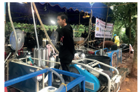
MARINER Anlagen von BAUER sicherten bei der Rettungsaktion die Luftversorgung.
