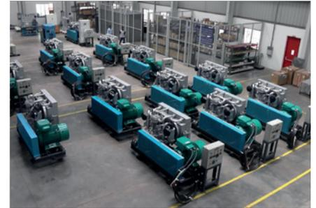
Beim Lift Irrigation Project sichern 13 leistungsstarke Bauer IK 28 Anlagen die Luftversorgung.
