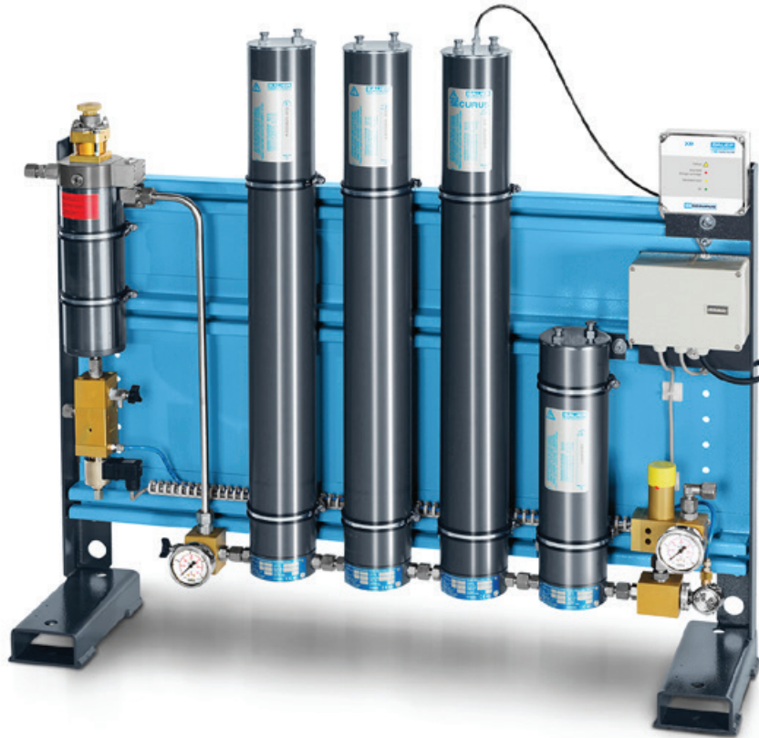
Filtersystem P 100 mit SECURUS, Kondensatablassautomatik und CO-Umwandlung
