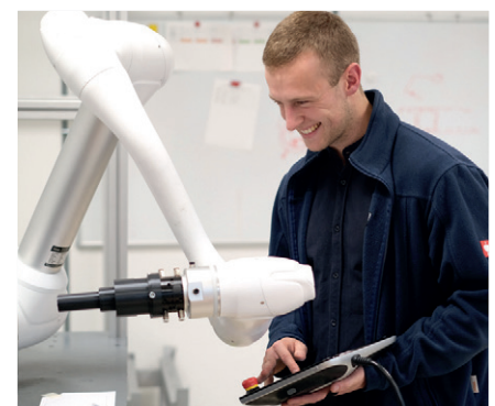
Stefan Fuchs beim Überprüfen der kollisionsfreien Entgratbahn bei einem Rotorengehäuse
