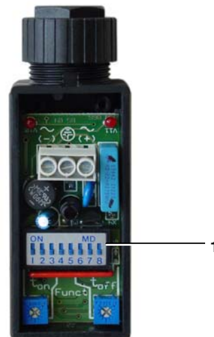
Fig. 52 Relè a tempo Q2 (motore a benzina)
